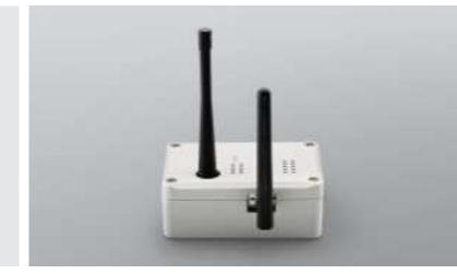
WaveNet RouterNode als Umsetzer von WLAN auf die 868 MHz Frequenz
