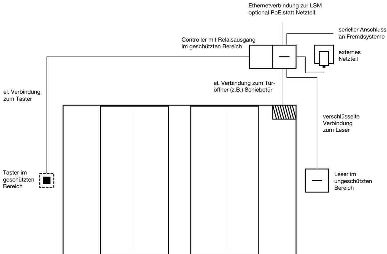
In diesem Anwendungsfall wird der Controller in einem geschützten Bereich (z.B. das Gebäudeinnere) montiert. Ein externer Leser wird auf der ungeschützten Seite der Tür angebracht und kann Identifikationsmedien auslesen.
