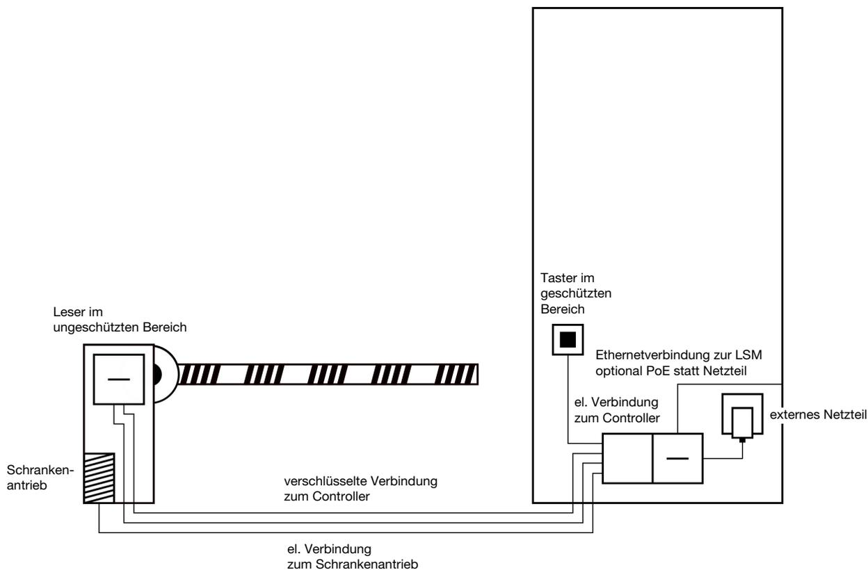
Das SREL3-ADV-System bietet dafür eine intelligente Lösung. Der Controller wird in einem geschützten Bereich montiert, zum Beispiel im Technikraum. Gleichzeitig wird ein Leser in der Nähe der Schranke benötigt. Dafür gibt es zwei Möglichkeiten:
