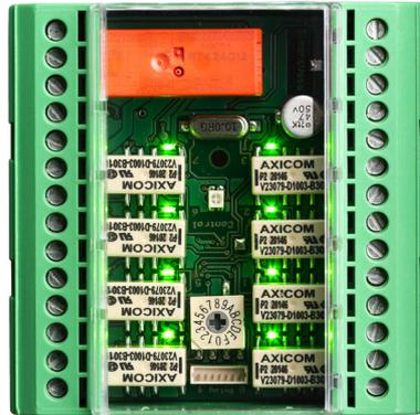
Die SmartOutput-Module sind die ideale Ergänzung zu den Controllern, sobald mehr als ein Relaisausgang benötigt wird. Jedes SmartOutput-Modul ist mit acht Relais mit je einem Wechselkontakt ausgestattet. SmartOutput-Module können in einer parallelen Schaltung miteinander verbunden werden und auf einer DIN-Hutschiene (35 mm \* 7,5 mm) montiert werden.
