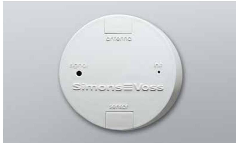
Er kann zur Vernetzung neben Schließungen ohne verfügbaren LockNode-Inside montiert werden. Er kommuniziert mit der Schließkomponente über die bewährte B-Feld-Schnittstelle (25 kHz) und mit dem nächstgelegenen RouterNode über die 868 MHz Funkschnittstelle (alternativ über eine RS485 Kabelschnittstelle).
