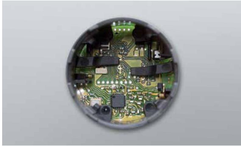
Der LockNode Inside wird in die Schließkomponenten integriert und ermöglicht so die direkte Vernetzung ohne zusätzliche LockNode-Montage neben der Tür.
